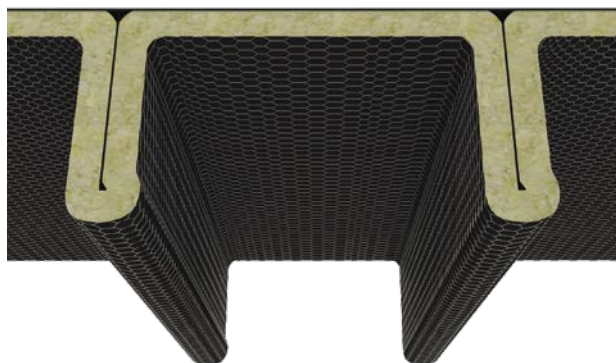
Instalación continua de panel cableado
